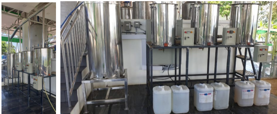
Gambar 40. Alat destilasi bioetanol tahap I yang tengah beroperasi
