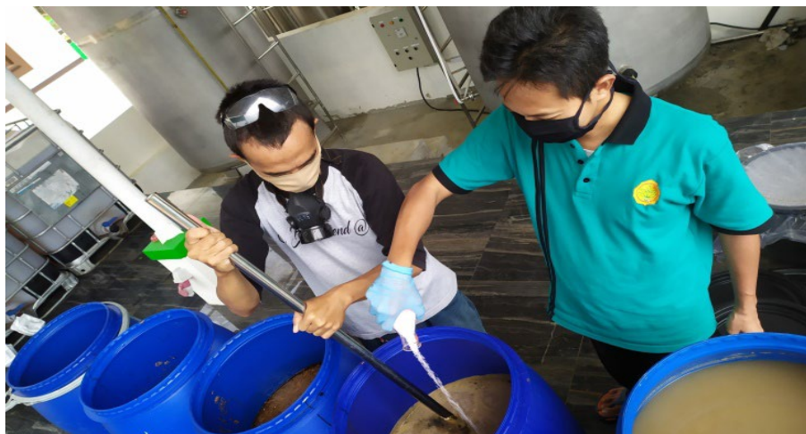
Gambar 46. Fermentasi Bioetanol dari Molase dengan Drum Plastik
