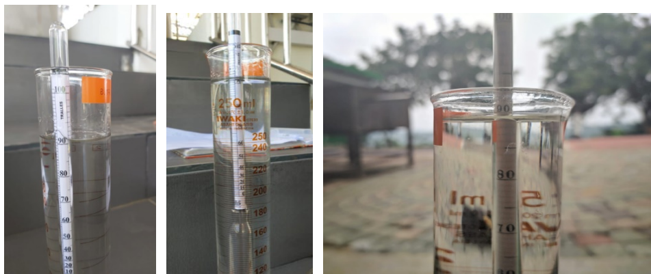
Gambar 41. Konsentrasi bioetanol hasil destilasi tahap II
