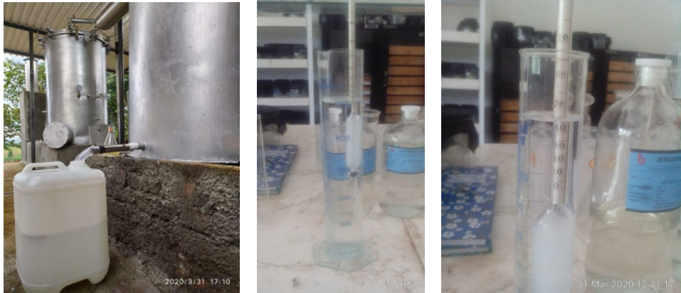
Gambar 39. Pipa keluar destilasi tahap I dan pengukuran kadar bioetanol yang dihasilkan
