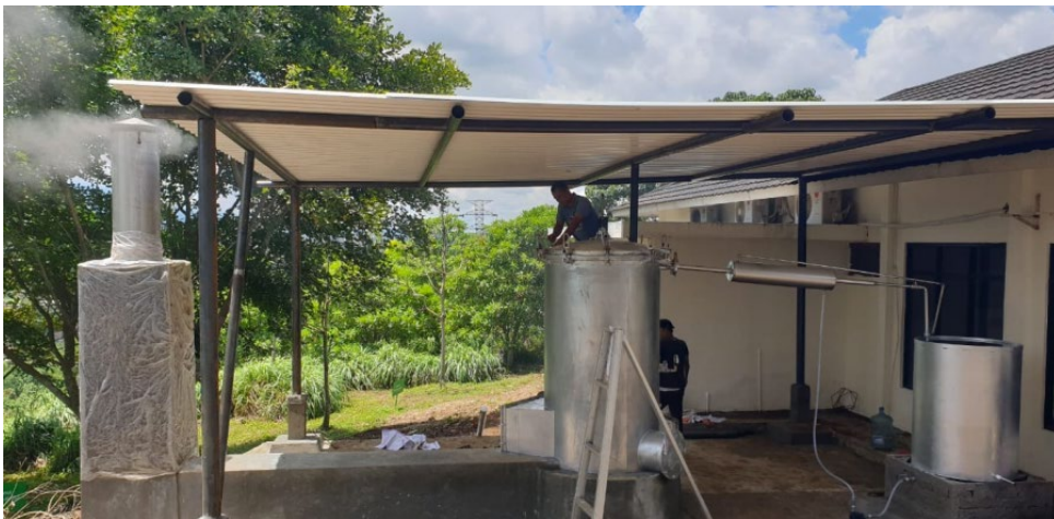
Gambar 38. Alat destilasi bioetanol tahap I yang tengah beroperasi
