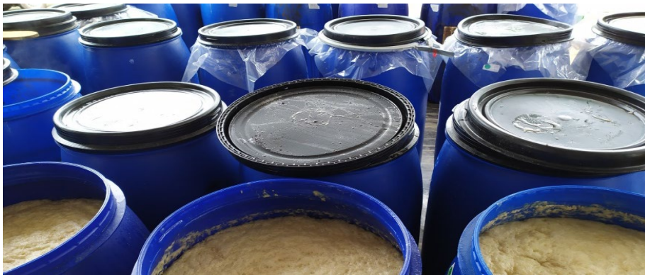
Gambar 44. Fermentasi Bioetanol dari Singkong dengan Drum Plastik
