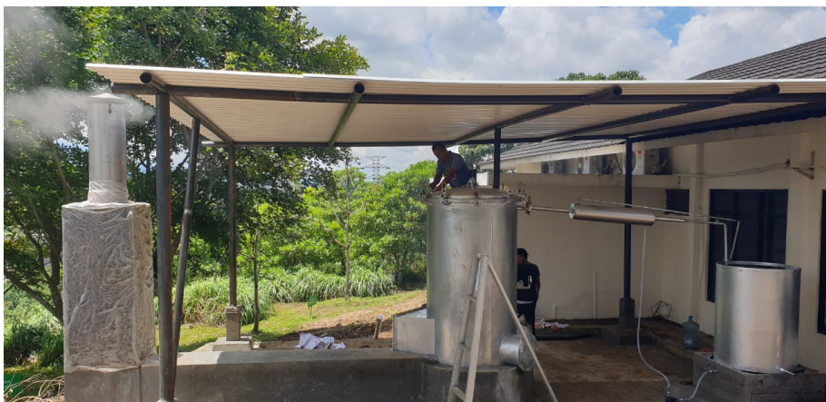
Gambar 45. Destilasi Tahap Pertama dengan Destilator Kapasitas 1500L/batch
